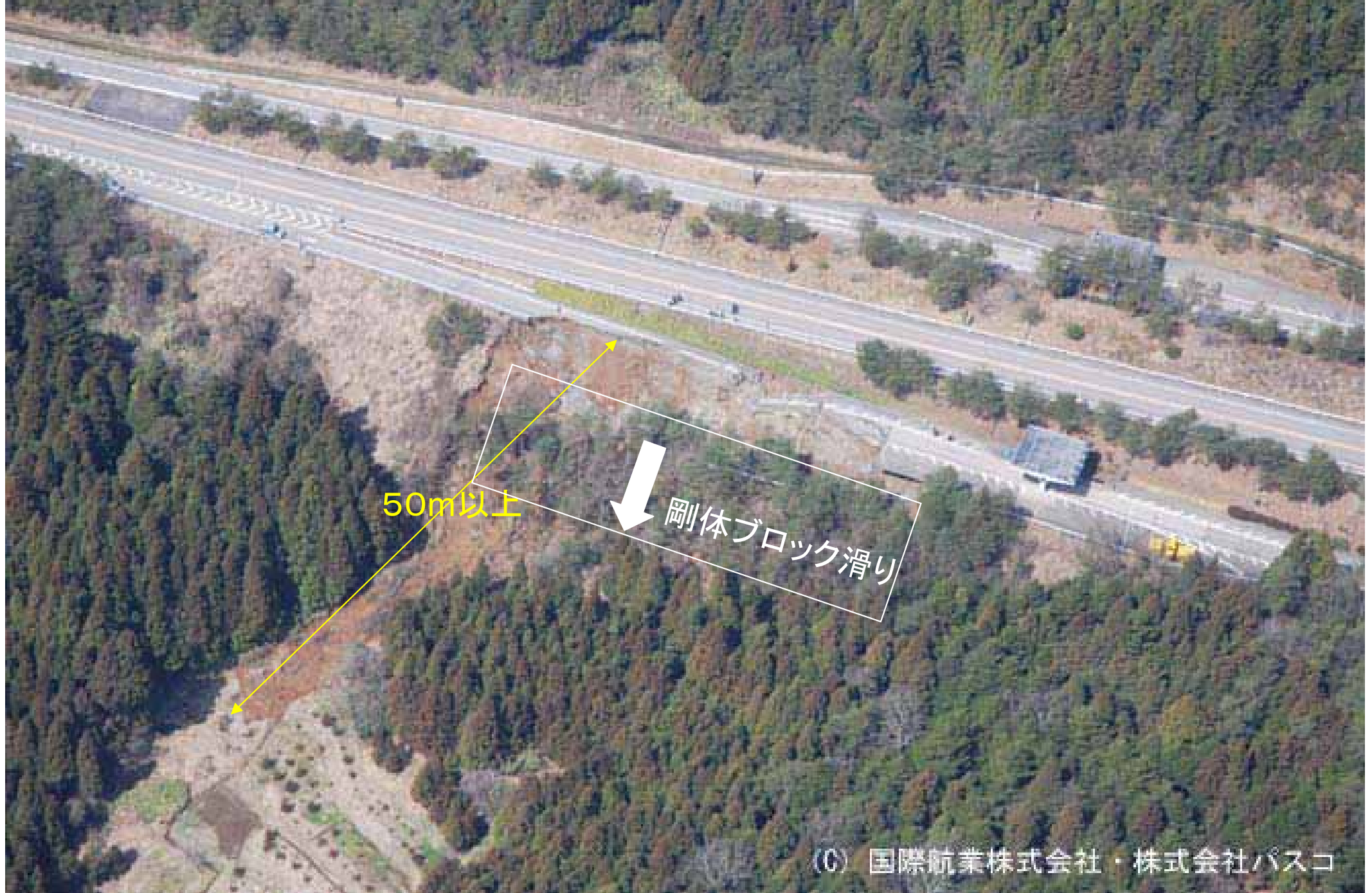
能登道路横田料金所付近盛土崩壊(国際航業HPより)
