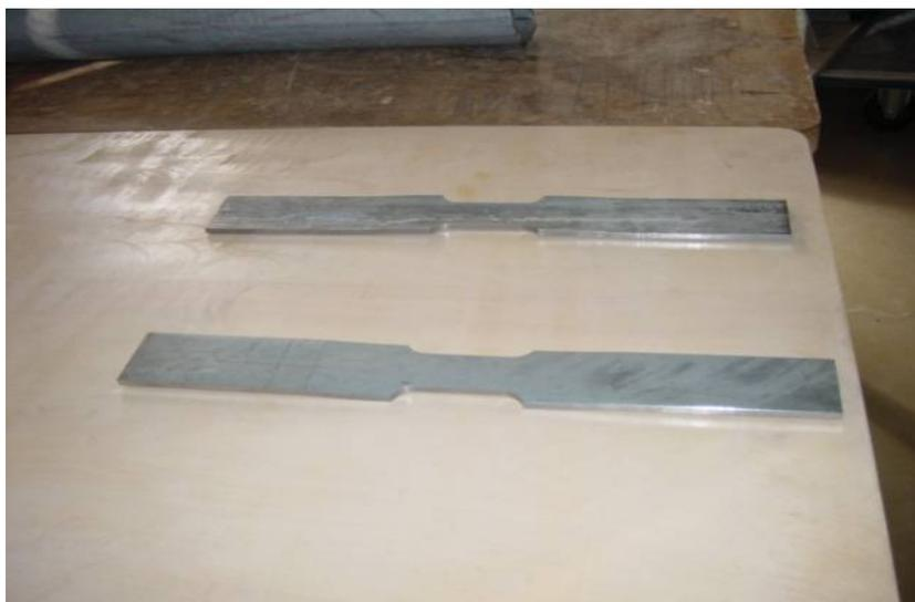
写真-4.3 引張試験供試体
