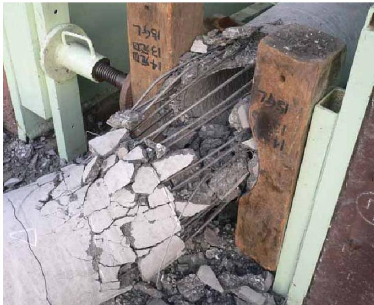
写真-3.20 曲げ破壊事例
