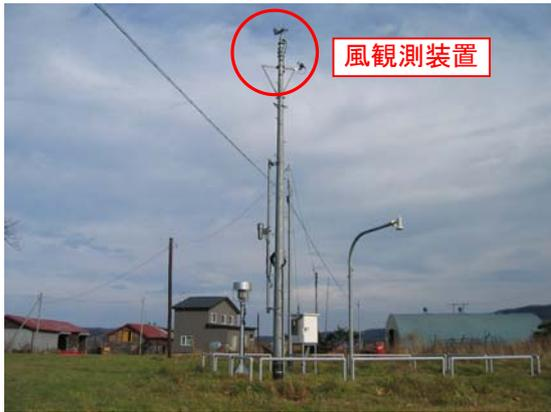
(a) 測風塔（風観測装置の地上高さは8.5m）
