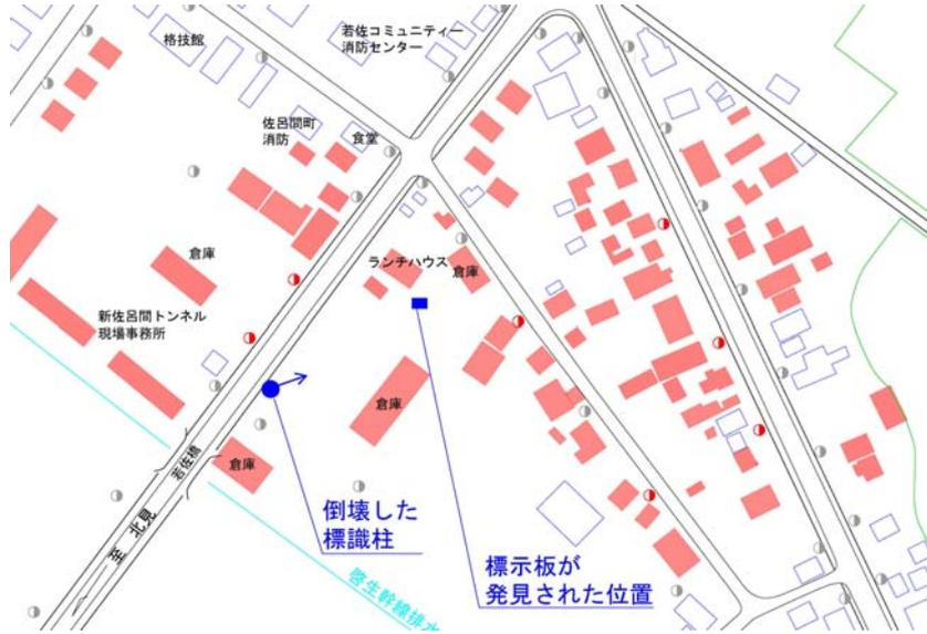
図-3.3 破断した標識の位置
