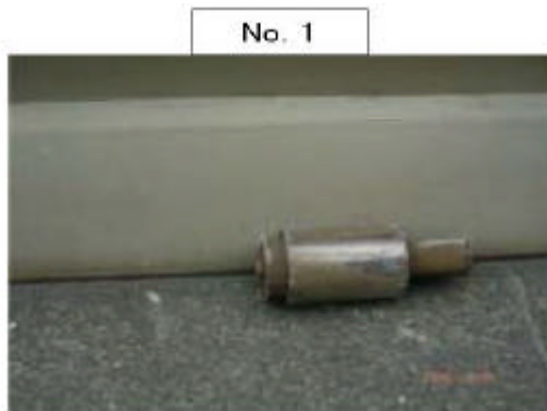
(a) 地面に落下したローラーの一部
