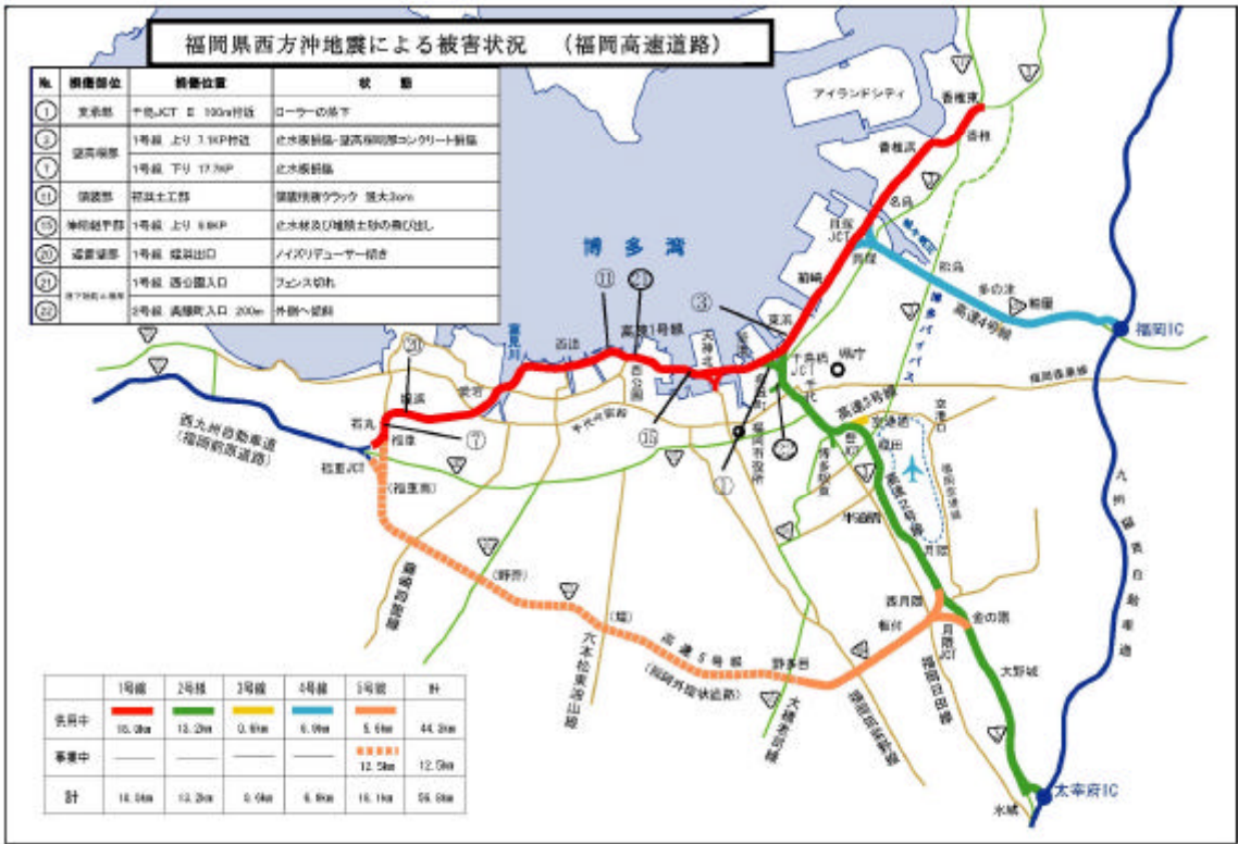
図 - 1 福岡都市高速道路の主な被害状況と発生位置
