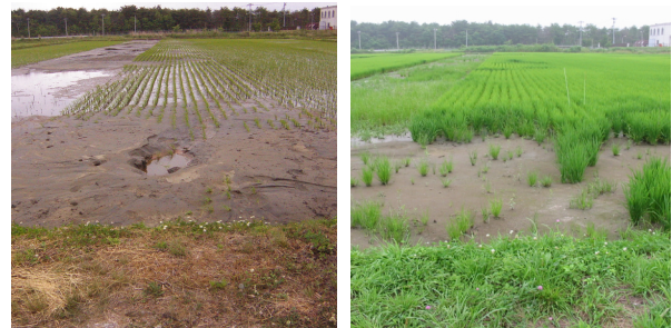
写真 8.1 鳴瀬町浜市地区の噴砂跡 (左：5.26 地震後、右：7.26 地震後)
