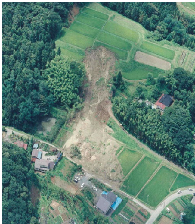
写真 7.9 泥流化した斜面災害の航空写真 (左：5.26 地震の筑館町、右：7.26 地震の河南町) —国際航業（株）提供—
