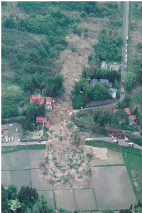
写真 7.9 泥流化した斜面災害の航空写真 (左：5.26 地震の筑館町、右：7.26 地震の河南町) —国際航業（株）提供—
