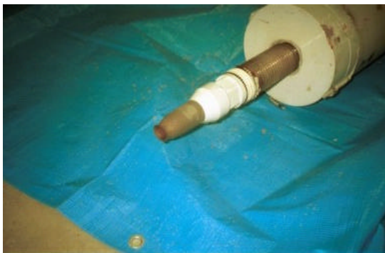
写真-5 センターステイロッドの破断の状況
