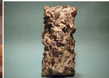
暴露試験2年後のコンクリート
