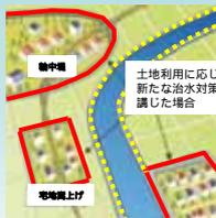
輪中堤や宅地嵩上げを効率的に短期間で実施することにより、家屋の浸水被害を解消 農地は相応の安全度の堤防
