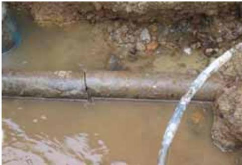
写真 9.1.4-3 100ACP の管体破損
