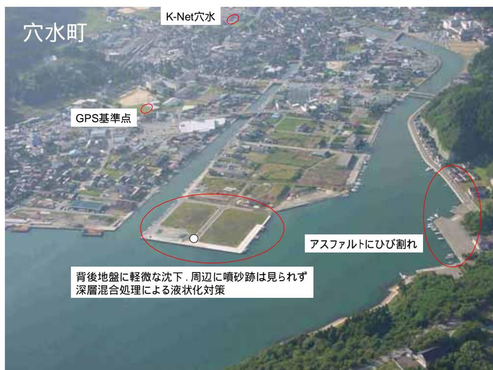
写真 7.2-1 穴水港の空中写真と周辺の状況<sup>5)</sup>に加筆
