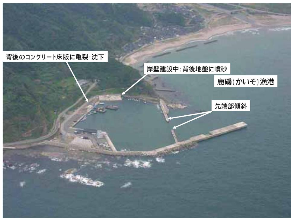
写真 7.4-1 鹿磯漁港の被災状況<sup>5)</sup>に加筆
