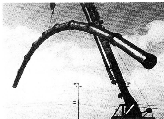
写真－４ 屈曲性のある耐震継手管
