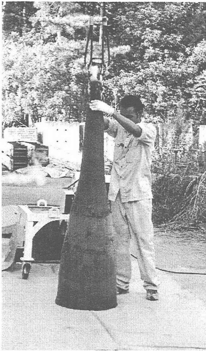
写真一2 凍結サンプリング試料全景
