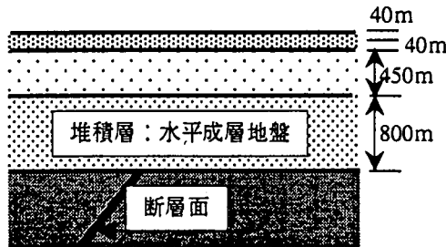
図-12 理論解析法による地盤構造モデル
