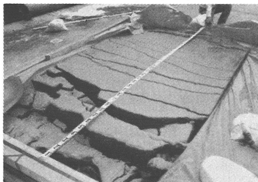
写真1 実験終了後の地表面状況
