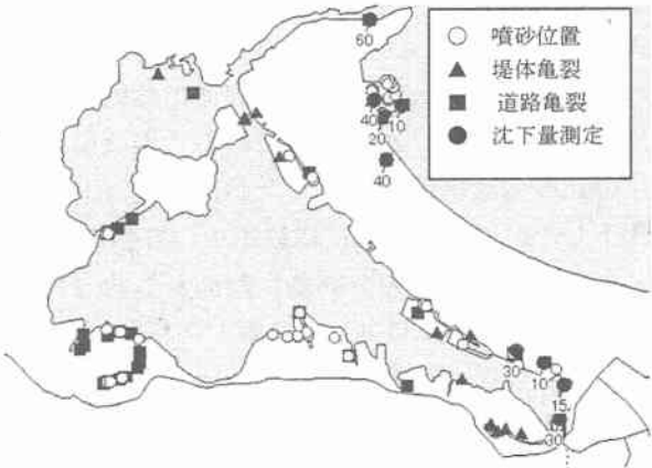
図-1 液状化被害箇所および地盤の沈下量
