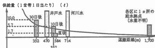
図-2 震災時の神戸市の緊急給水状況
