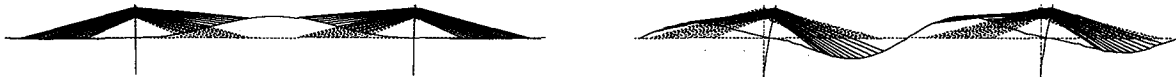
(a) 1次モード (b) 2次モード 図-6 エクストラードズド橋 (ラーメン型式) モード図
