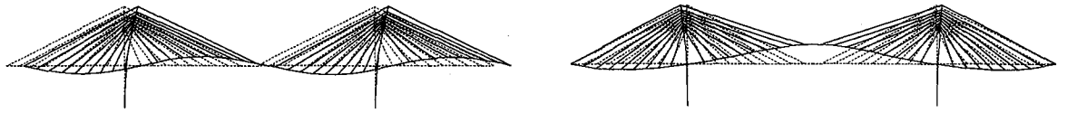
(a) 1次モード (b) 2次モード 図-5 PC斜張橋 (サスペンデット型式) モード図
