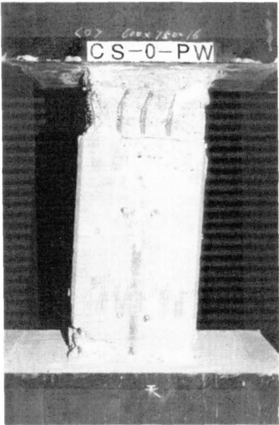
写真-5 補強材撤去後供試体(鋼板接着工法)
