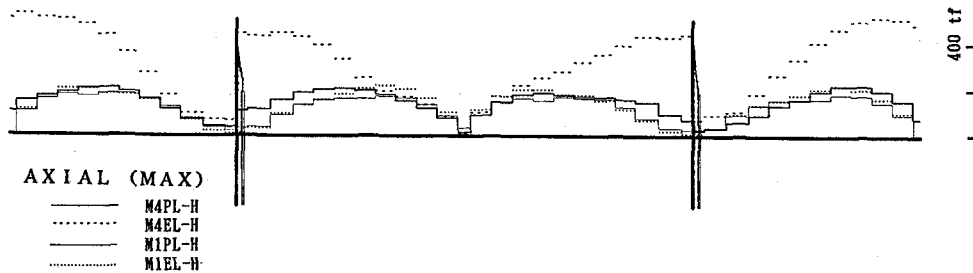
図-12.2 最大応答軸力分布(八戸波:モデル1と4)
