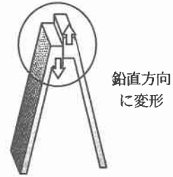
図-5 免震デバイスのモデル図
