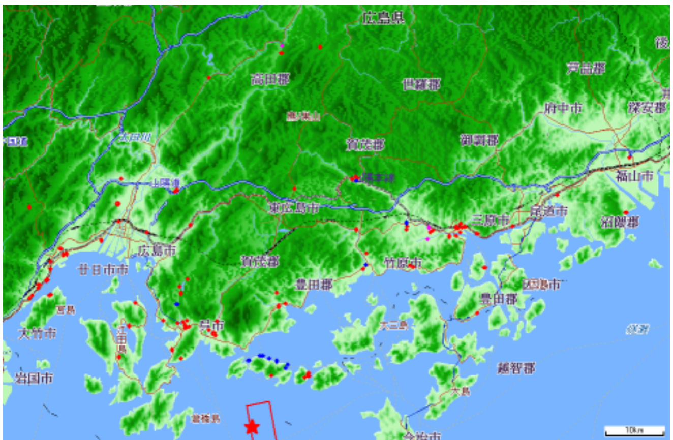
図-1 広島県下の配水管路の被害位置
