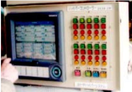
写真-1 三次元同時注入管理システム
