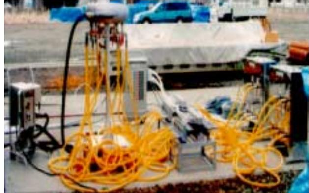
写真-2 三次元同時注入システム
