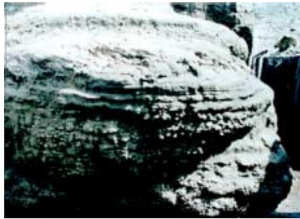
写真-4 柱状浸透積層注入によるパーマロック・ASFの固結体
