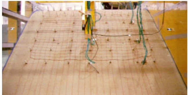
写真 - 1 : ロックボルトとロープネットによる対策工
