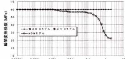
図-18 瞬間変形係数のひずみ依存性(砂質土)
