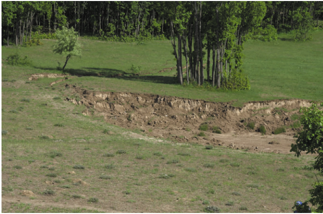
写真-4 側方流動の最上部
