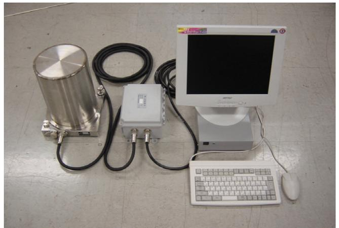
写真-1 早期警報用地震計の試作機(左から速度計, 加速度計, 処理装置)
