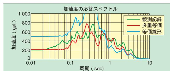
図-8 多重等価線形法による液状化解析
