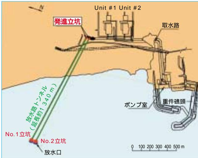
図-2 龍門（核四）原子力発電所平面図
