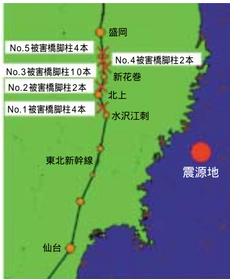
図-4 新幹線高架橋の被害位置
