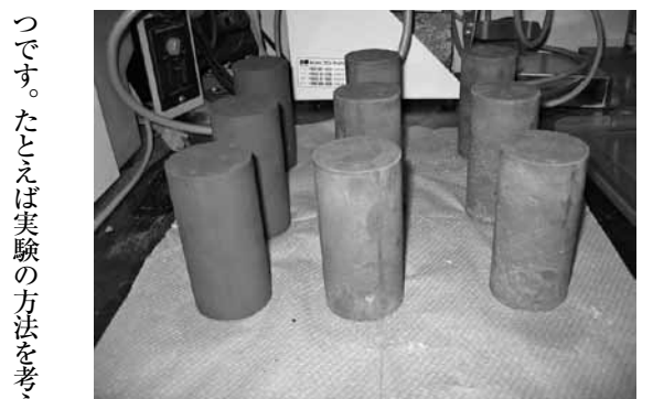
写真3 セメント改良土の供試体
