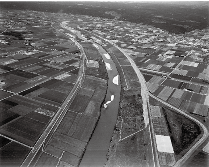
写真1 自由砂州の例。川の中に見られる半月型の陸地が自由砂州(交互砂州)。自然と左右交互規則的に発生する(写真提供: 山口甲氏)
