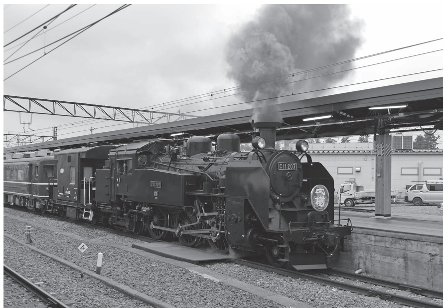
写真1 蒸気機関車とATS機器を搭載した車掌車(機関車後方)
