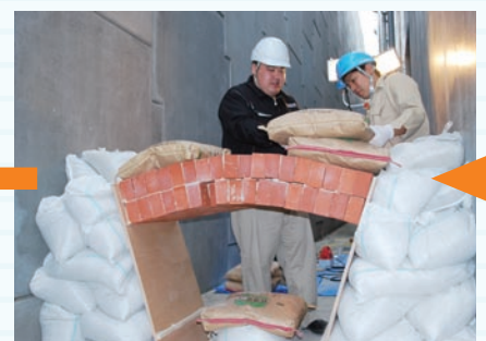
写真4 砂袋による載加重実験
