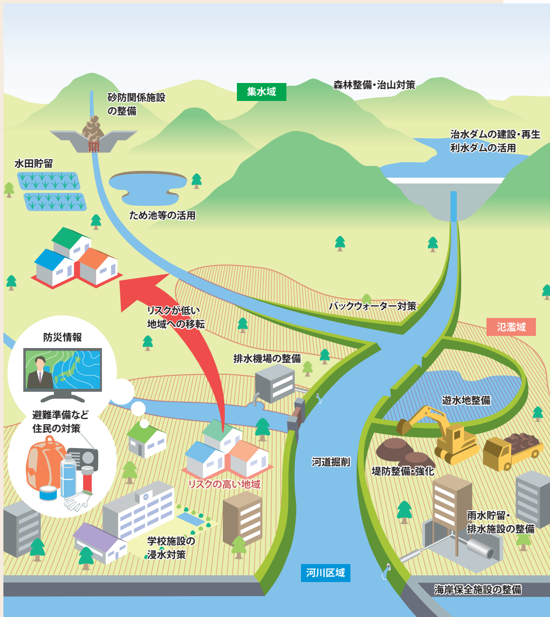
図1 流域治水の概要 (国土交通省の流域治水のイメージ図を参考に作成)
