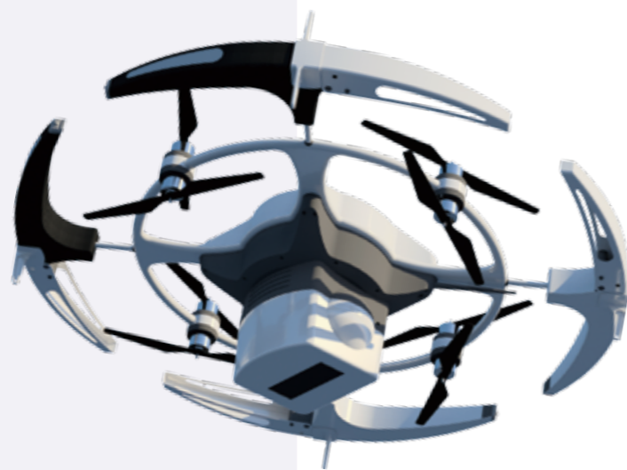
最も普及が進むマルチコプターと呼ばれるタイプのUAVであるZUAV (提供：(株)アミューズワンセルフ)
