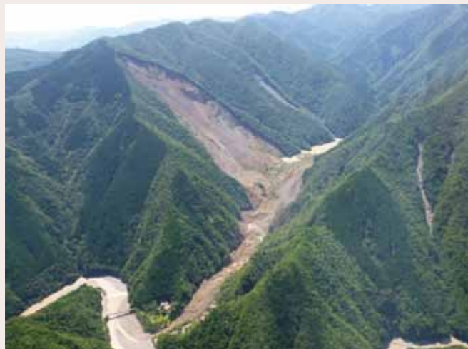
2011年台風12号により奈良県五條市大塔町赤谷地区で発生した深層崩壊と天然ダム (撮影: 国土交通省近畿地方整備局)
