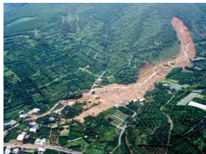
1997年鹿児島県出水市針原川流域で発生した深層崩壊 (撮影：国際航空写真(株))
