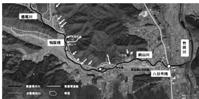
図2 前山川における調査域(矢印は土砂崩壊箇所)
