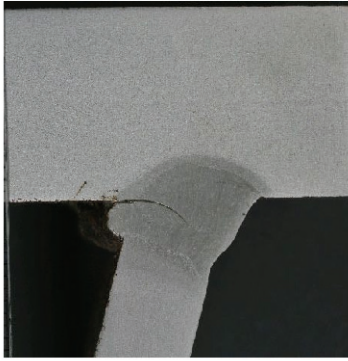
写真-3 再現した疲労き裂
