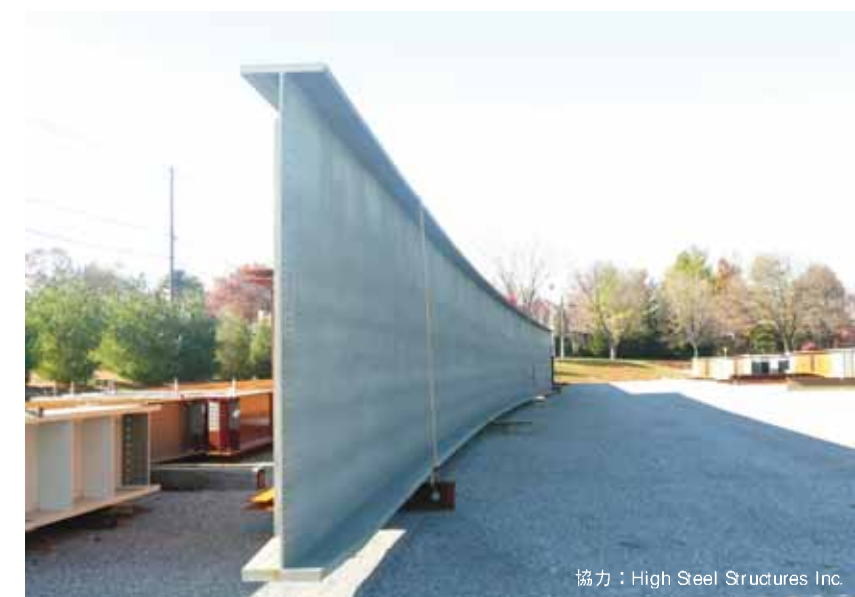
溶接により製作されたHPS485WのLong span girder (約28m)
