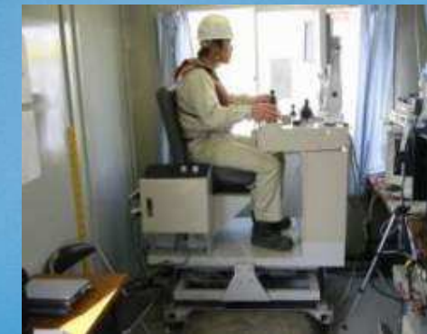
遠隔操縦装置全景 (操作中)
