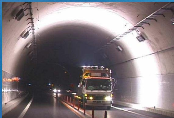
コンクリート構造鬱ひび割れ検出システム
