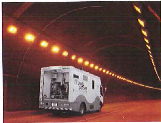
図-3 レザー光によるひび割れ計測の例
