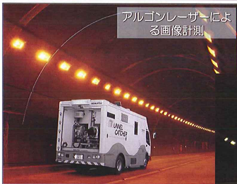
3CCDデジ列ビデカメラ による画像計測
