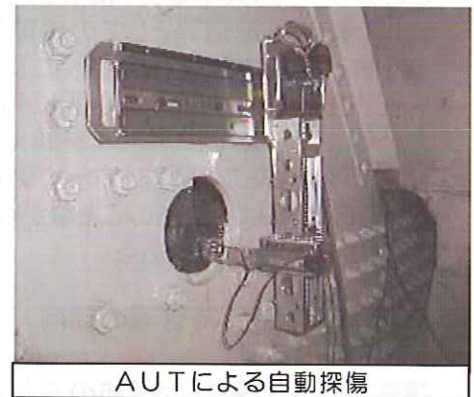
図4 疲労亀裂非破壊探傷試験の例
