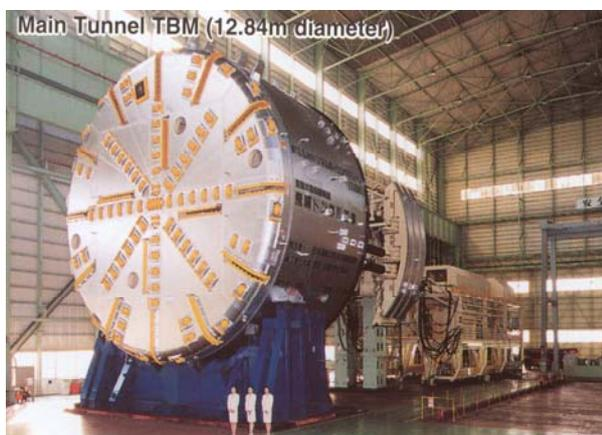
図-2 飛驒トンネルの大断面TBM
