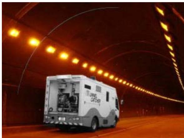
図-3 レザー光によるひび割れ計測の例
