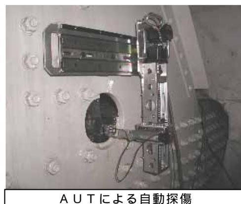
図4 疲労亀裂非破壊探傷試験の例
