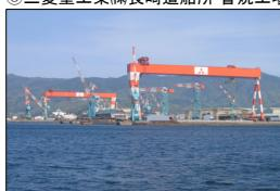
日本最大の乾ドック100万トンドックのある三菱重工香焼工場。赤と白のアーチ型クレーンは、別名「ゴライアス・クレーン」と言われ、この1基で800t、60人乗り大型バスを50台吊り上げができる。
