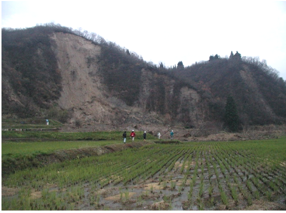
写真 2-11 旧堀内町竜光の表層崩壊 (崩壊地上端から崩土末端前の距離/比高=0.47 であり流動性が高い崩壊, R11.25 撮影)
