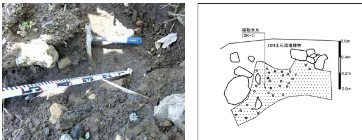
図 3.3.5.1 土石流堆積物中の木片(SK-1)採取箇所(左)と深度方向概況図(右)
