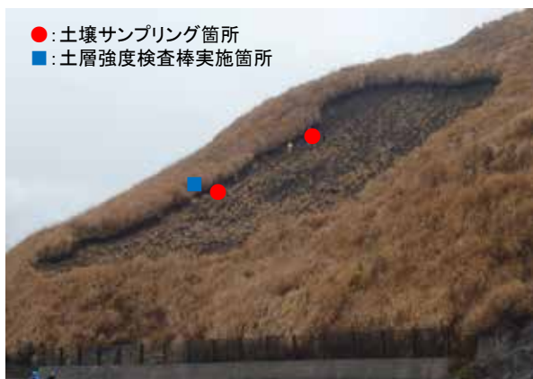
写真 3.3.4.8 崩壊右側方部での土層強度検査棒試験状況
