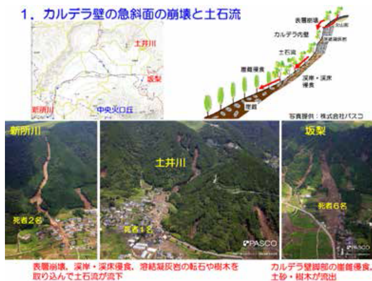
図 2.2.2 カルデラ壁の急斜面の崩壊と土石流
