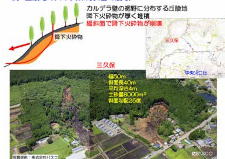
図 2.2.6 丘陵地の降下火砕物斜面の崩壊
