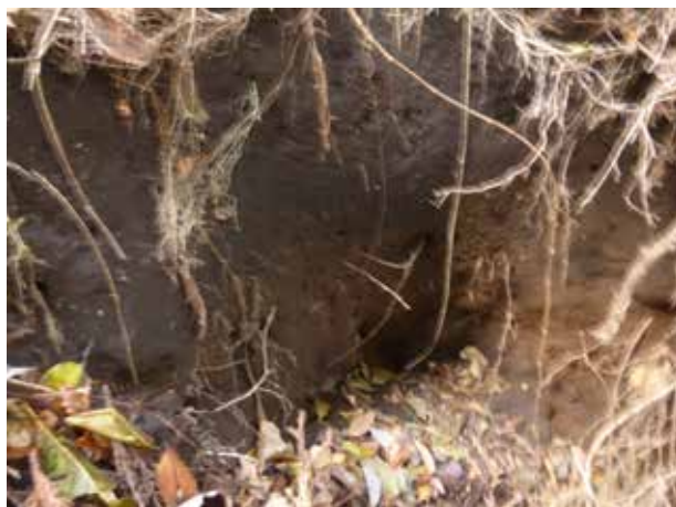
写真 3.3.7.4 窪地における土壌のパイプ化
