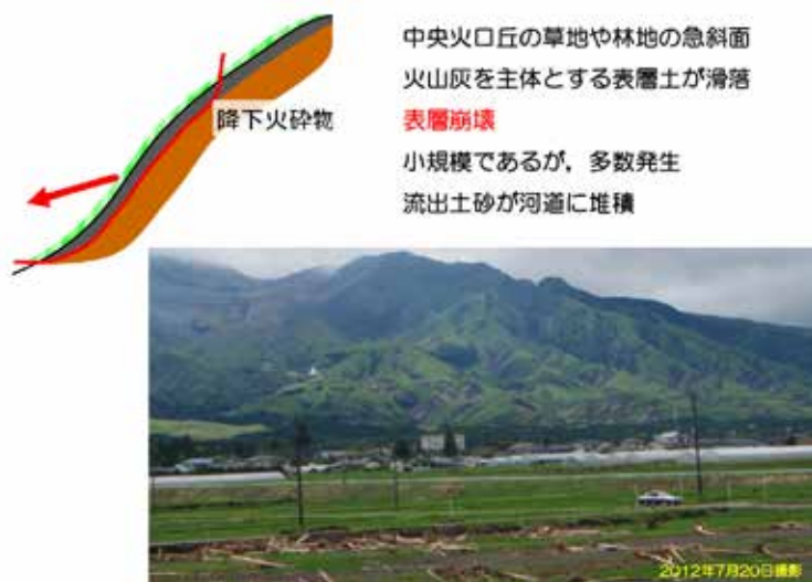
図 2.2.7 中央火口丘の急斜面の崩壊
