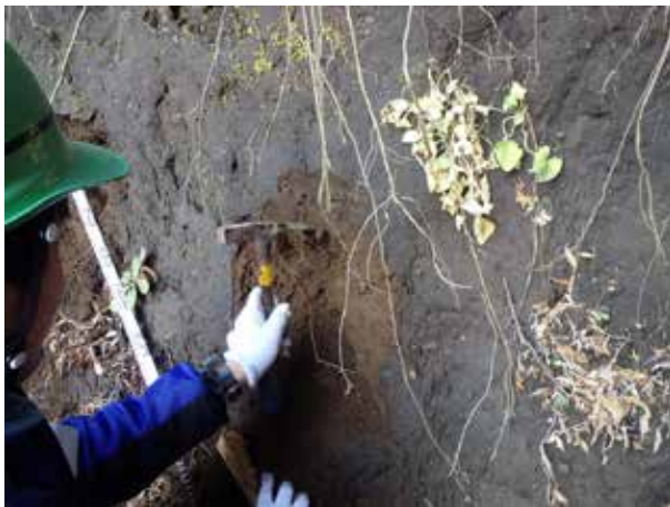
写真 3.3.3.6 滑落崖に露出する黒ぼく層
