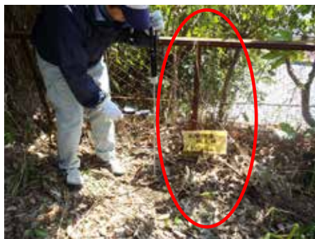
写真 3.3.4.1 ベーンコーンせん断試験の計測状況 (写真左) 及び ロッド先端のベーンコーンの形状 (写真右)
