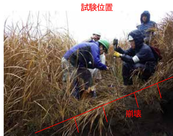
写真 3.3.4.8 崩壊右側方部での土層強度検査棒試験状況
