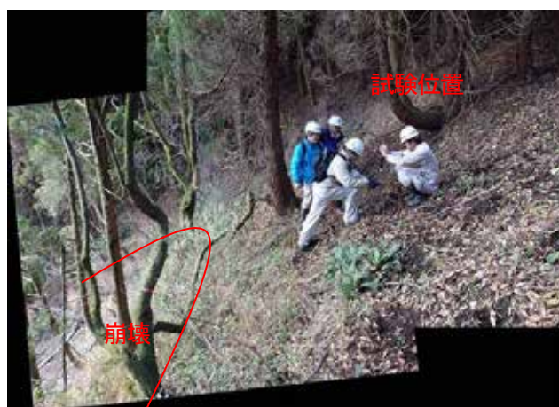
写真 3.3.4.4 滑落崖上方での土層強度検査棒試験状況
