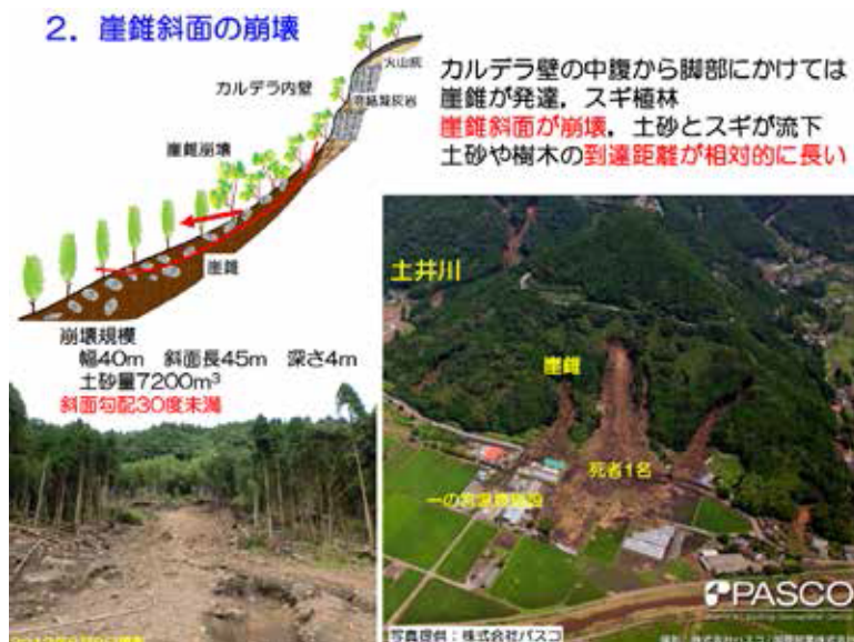
図 2.2.5 崖錘斜面の崩壊
