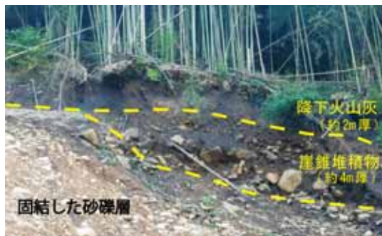
滑落崖の断面 固結砂礫層が基盤となり上の崖錐堆積物と火山灰層が崩壊。固結砂礫層の凹凸に応じて、崖錐堆積物の厚さがほぼ0から最大5mと場所により異なる。
