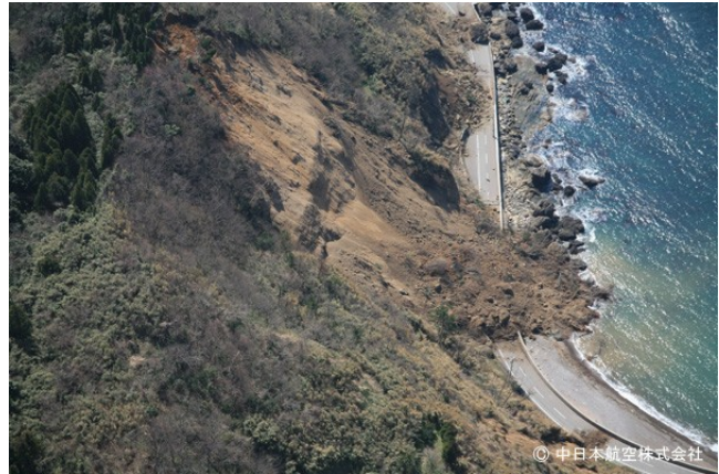
写真 5.1.5 最大規模の崩壊(S-13 地点)と上は S-14 地点 (中日本航空株式会社撮影)
