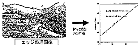
(b) ボックスカウンティング法による景観の形状解析
