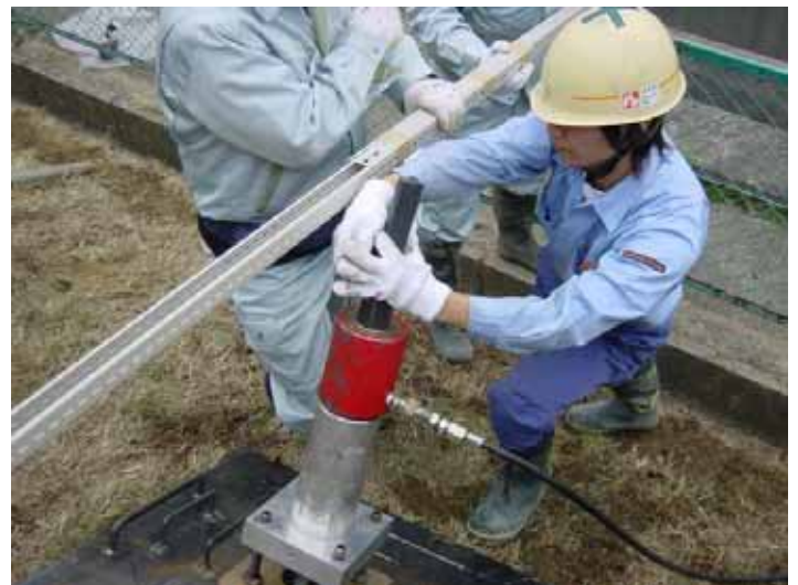
コピー ~ DSC00005.JPG 2003/11/27 13:15:19 引抜試験
