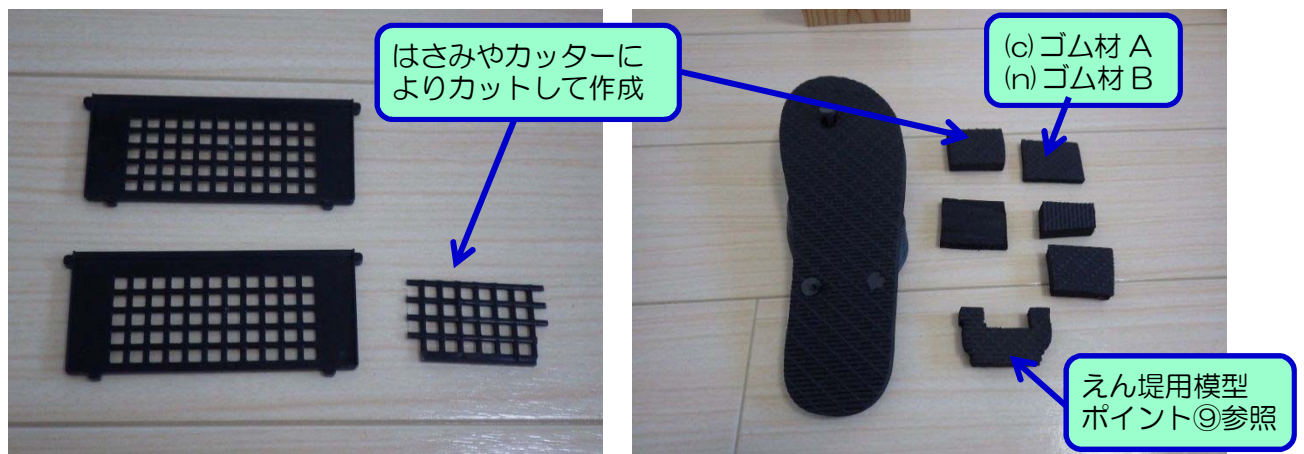
(d) メッシュ材と(c) ゴム材 A、(n) ゴム材 B の材料と加工
