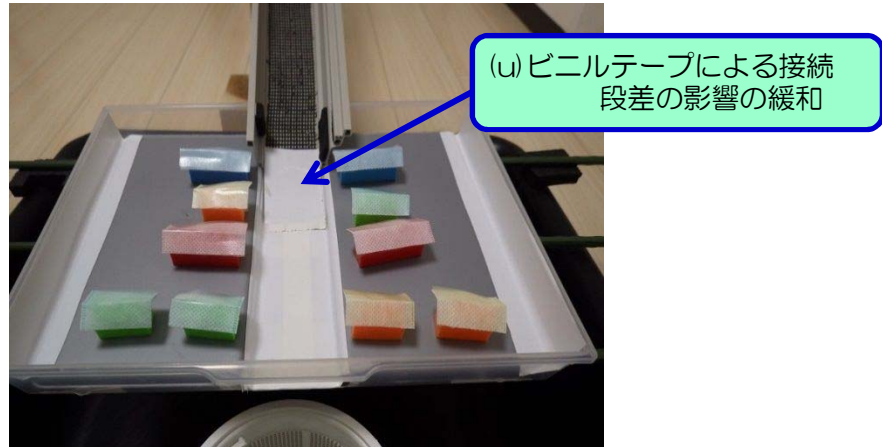
(u) ビニルテープによる流水路と住宅地模型の接続
