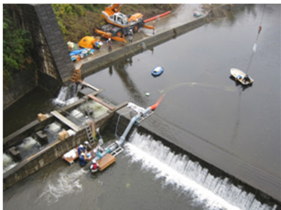
図-2 潜行吸引式排砂管の現地実験の様子
