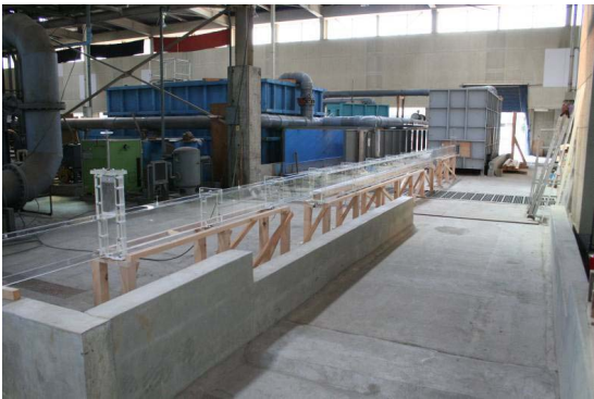
図-1 侵食実験水路の概要（下流から撮影）
